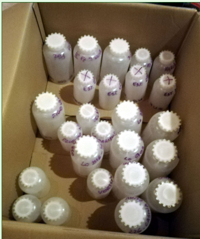
Foto 14. I contenitori utilizzati per la protezione dei data logger, con fondo tagliato e buchi laterali di areazione - Foto M. Pozzo
