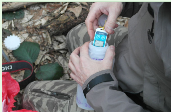
Foto 7. Inserimento del data logger all'interno del barattolo di plastica creato lateralmente e nella parte inferiore - Foto V. Franchini
