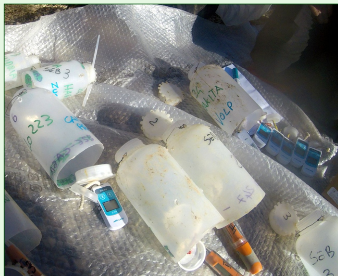
Foto 6. I numerosi data logger, pronti per essere inseriti all'imbocco degli ingressi, negli appositi contenitori di protezione - Foto V. Franchini
