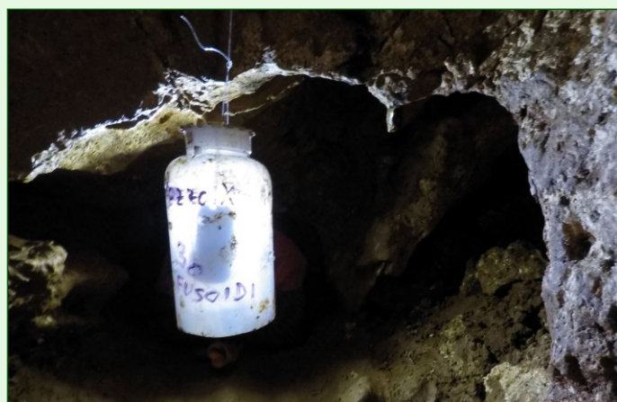
Foto 9. Il sistema di fissaggio dei data logger all'interno di un barattolo di plastica areato - Foto M. Pozzo
